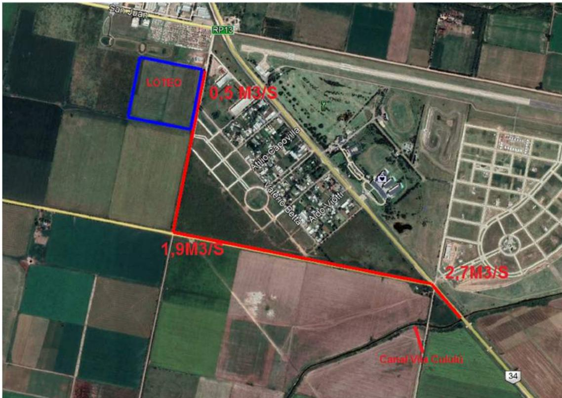
Para realizar el dimensionamiento de la secciones de la cuneta en estudio se utilizó el software HEC-RAS 4.1.
